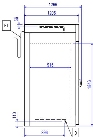
EI = Conexión eléctrica (energía)
